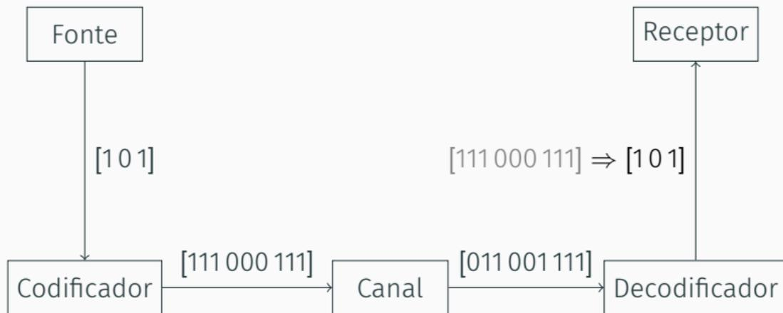
**Figura 2:** Exemplo de transmissão de uma palavra  $m$  através de um canal que produziu o erro  $e = [100\ 001\ 000]$ , usando um Código de Repetição.
