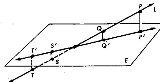
Na figura,  $P'$  é a projeção de  $P$ ,  $Q'$  é a projeção de  $Q$ ,  $S'$  é a projeção de  $S$  e assim por diante. A figura sugere que a projeção de uma reta é sempre uma reta; e, de fato, é isso que sempre acontece, salvo quando a reta e o plano são perpendiculares como na figura à direita. Aqui  $A$  é a projeção de todos os pontos  $P$  da reta e portanto  $A$  é a projeção da reta toda. Para obtermos um teorema verdadeiro precisamos eliminar essa possibilidade.
