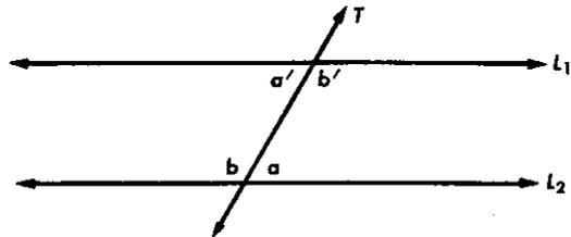
Isto é, se  $\angle a \cong \angle a'$ , então  $\angle b \cong \angle b'$ . E se  $\angle b \cong \angle b'$ , então  $\angle a \cong \angle a'$ . A demonstração fica para você.
