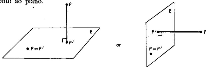
Pelo Teorema 8-9, existe uma e uma só perpendicular nessas condições. Em cada uma das figuras,  $P'$  é a projeção de  $P$  sobre  $E$ . Permitimos a possibilidade de  $P$  estar em  $E$ . Nesse caso, a projeção de  $P$  é  $P$  mesmo.
