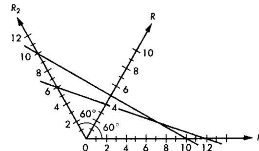
e  $R$  é lido na escala que sobrou. Por exemplo, se  $R_1 = 12$  e  $R_2 = 6$ , então  $R = 4$ ; se  $R_1 = 10$  e  $R_2 = 10$ , então  $R = 5$ .
