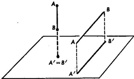
Por exemplo, a projeção de um segmento é, em geral, um segmento, apesar de, em alguns casos, poder ser um ponto. Análogamente a projeção de um triângulo é, em geral, um triângulo, apesar de poder ser um segmento.
