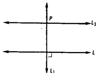
*Demonstração.* Seja  $L_1$  a perpendicular a  $L$  por  $P$ . Seja  $L_2$  a perpendicular a  $L_1$  por  $P$  (no plano que contém  $L$  e  $P$ ). Pelo Teorema 9-2,  $L_2 \parallel L$ .
