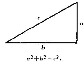
*Demonstração.* Primeiramente, tomamos um quadrado com lados de comprimentos  $a + b$ . No quadrado, traçamos quatro triângulos retângulos com catetos  $a$  e  $b$ .
