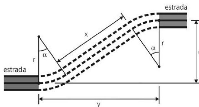
a) Se o engenheiro adotar  $\alpha = 45^\circ$ , o segmento central medirá  $x = d\sqrt{2} - 2r(\sqrt{2} - 1)$ . Nesse caso, supondo que  $d = 72$  m, e  $r = 36$  m, determine a distância  $y$  entre as extremidades dos trechos a serem interligados.
