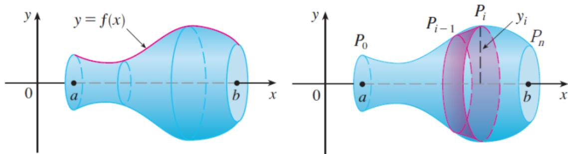
**Área total da superfície de revolução:** é a soma das áreas de pequenas faixas (=rotação de um pequeno segmento de curva). Vamos dar a formula para a rotação ao redor do eixo  $x$ :
