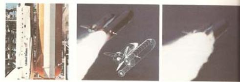
O ônibus espacial Challenger explodiu em 1986 devido a uma falha em um anel de vedação em um dos foguetes a propulente sólido
