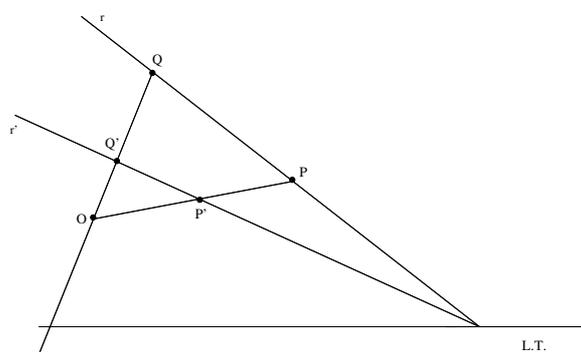
**Resultado 6 :** Dados a linha de terra, o ponto  $O$ , um ponto  $P$  e sua imagem  $P'$ , determinamos a posição da reta  $v$  da seguinte maneira. Traçamos a reta  $r$  perpendicular à linha de terra e que passa em  $P$  e determinamos a sua imagem  $r'$ . Traçamos por  $O$  a reta paralela a  $r'$  e determinamos o ponto  $r \cap s = V$ . Observe que este ponto está em  $v$  ou seja é um ponto do plano objeto que não tem imagem.
