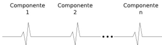
Para que o sistema continue funcionando, todos os componentes devem funcionar simultaneamente, isto é, se um falhar o sistema pára. Assim:
