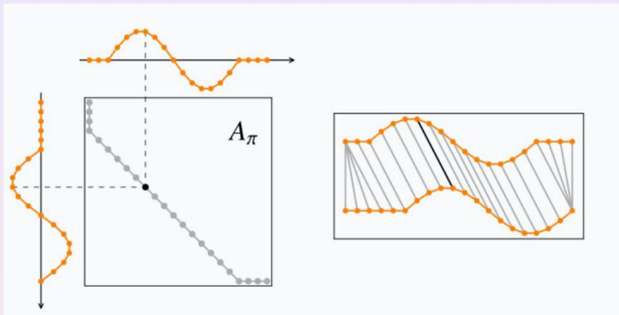
Figura 1: Caminho DTW representado como matriz binária (esquerda). Cada ponto no caminho indica uma entrada não nula em  $A_\pi$ , logo a coincidência entre um elemento de  $x$  com um elemento de  $y$ . Note a correspondência entre esta representação e aquela à direita.
