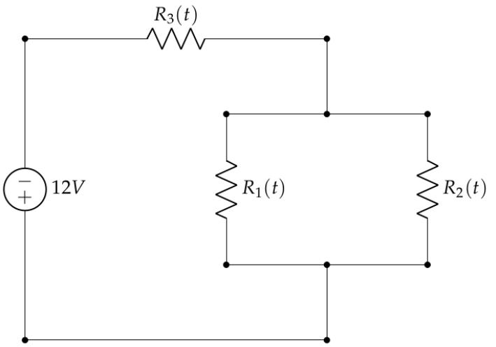
Os resistores não conseguem manter sua resistividade constante (devido a variação da temperatura do ambiente e no componente, por exemplo). Seja  $t_0$  um instante de tempo onde  $R_1(t_0) = 20\Omega$ ,  $R_2(t_0) = 30\Omega$ ,  $R_3(t_0) = 3\Omega$  e as taxas de variação deles são, respectivamente  $0,5\Omega/s$ ,  $1\Omega/s$  e  $0\Omega/s$ . Determine, no instante  $t_0$ :
