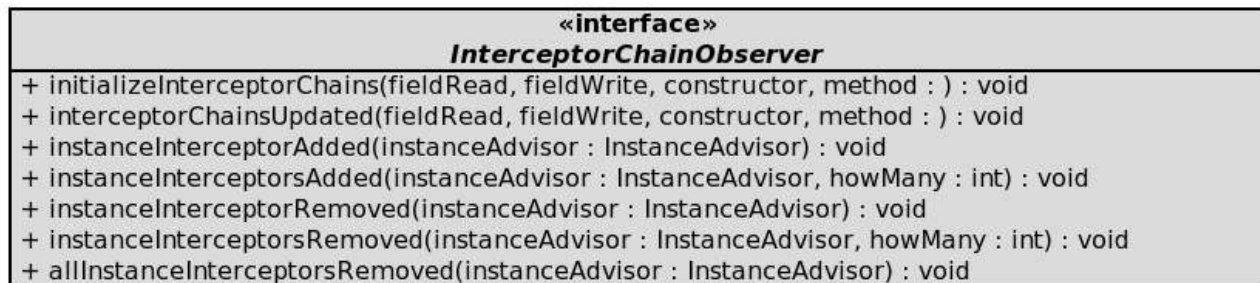
Fig 2- métodos disponibilizados pela interface org.jboss.aop.InterceptorChainObserver .
