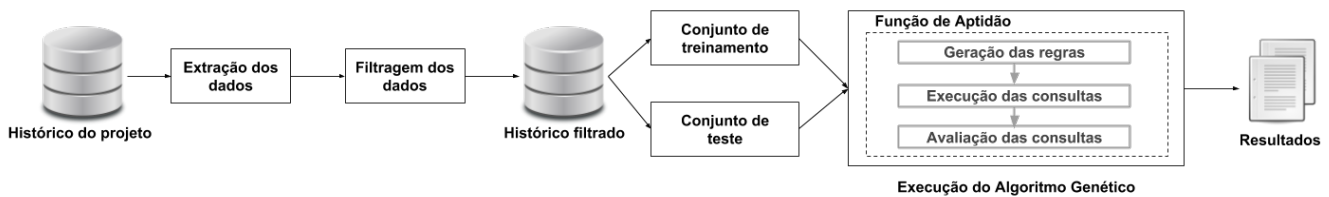
Figura 1: Visão geral da abordagem de recomendação de mudanças baseada em Algoritmo Genético.
