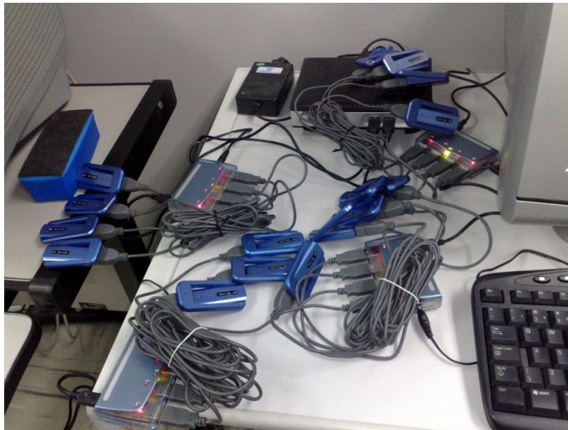
Figura B.4: O paradoxo da comunicação sem fios: teste de funcionalidade com 16 adaptadores Bluetooth
