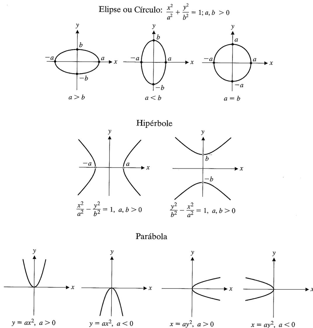
Figura 4 As cônicas não degeneradas na posição padrão
