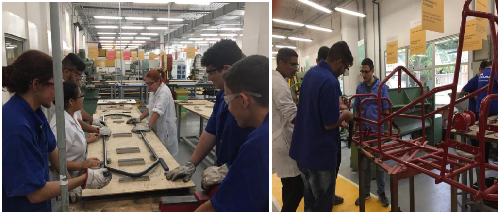
Figura 2 – Início da construção do chassi do carrinho Fonte: Acervo da 1ª Autora
