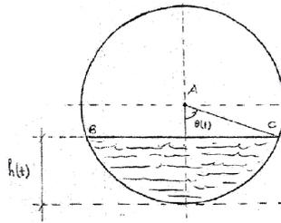
No instante em que a altura  $h$  do líquido é de 0,5 m, a vazão é de  $0,9\text{m}^3/\text{min}$ . Determine a taxa de variação do ângulo  $\theta$  no instante em que a altura do líquido é de 0,5m. Determine a taxa de variação da altura  $h$  do líquido neste mesmo instante. Resp.:  $0,2\text{rad}/\text{min}$ ;  $\frac{\sqrt{3}}{10}\text{m}/\text{min}$ .
