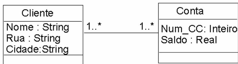
Figura 1.4 - Diagrama UML Cliente - Conta Corrente
