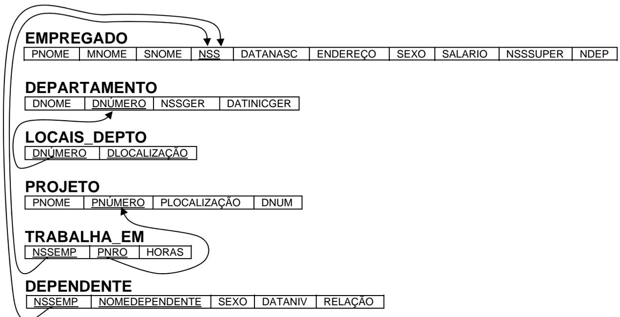
Figura 5.5 - Esquema COMPANHIA com restrições de integridade
