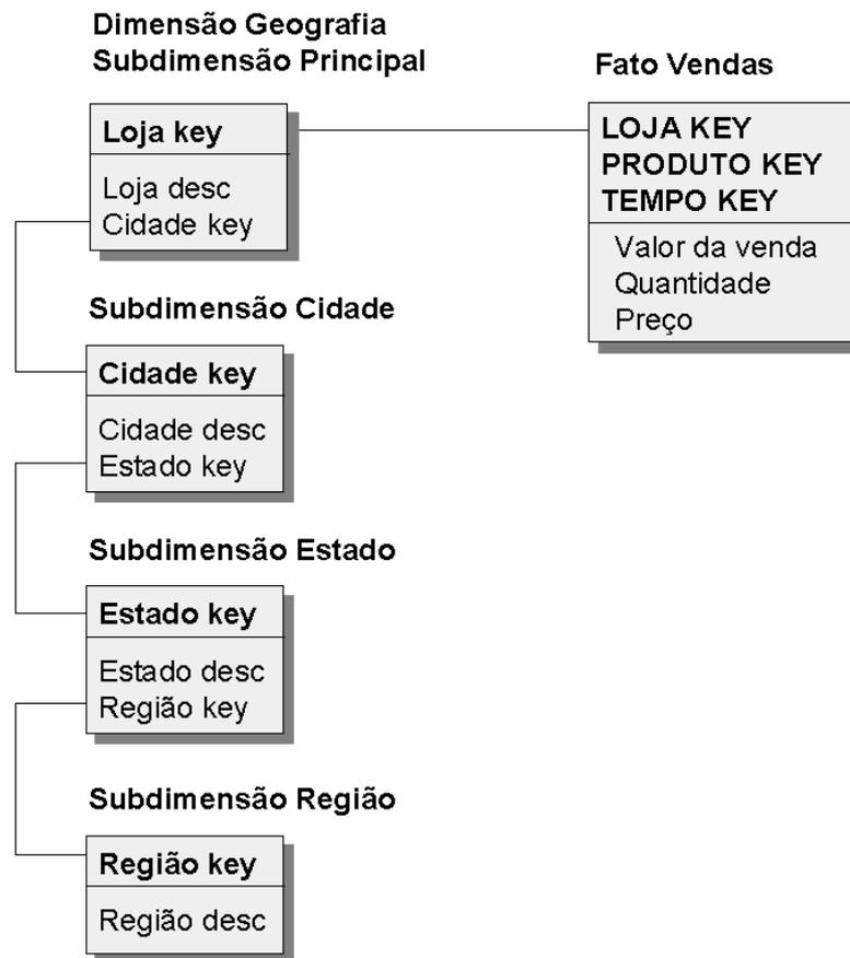
**Figura 18 – Exemplo de implementação do esquema Snowflake Chain, representando a ligação da tabela Fato com a dimensão Geografia (dividida em subdimensões encadeadas).**
